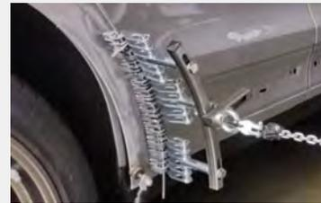
Le kit multi-crochets avec option griffe puller est une solution complète pour la réparation des dommages importants sur la carrosserie des véhicules.
