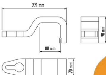
Le Flashgrife est une ancre à tir rapide en érable à haute résistance et à faible résistance. Il peut être facilement appliqué dans de nombreuses positions de la carrosserie.
