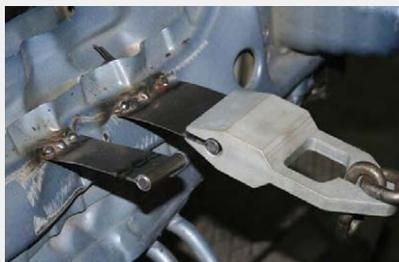
Robuste et conçu pour l'acier, cet étau de tirage inclut un kit de plaquettes de différentes tailles (1", 2", 75mm) et offre une force de traction de 3 tonnes.
